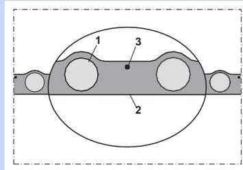
Antistatischer PVC Schlauch, superschwer, kälteflexibel, Erdungslitze (bis -25°C)
